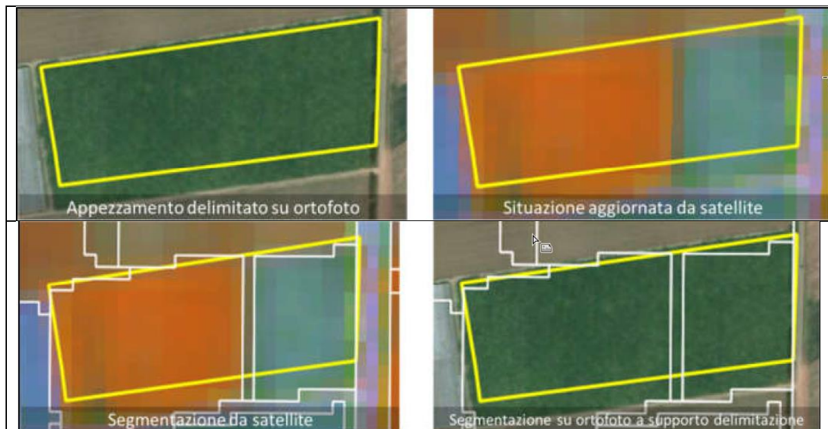
Figura 10 - Esempio di come i layer di segmentazione possono supportare una corretta delimitazione geografica dell'appezzamento, evidenziando la presenza di più colture all'interno dell'appezzamento originario
