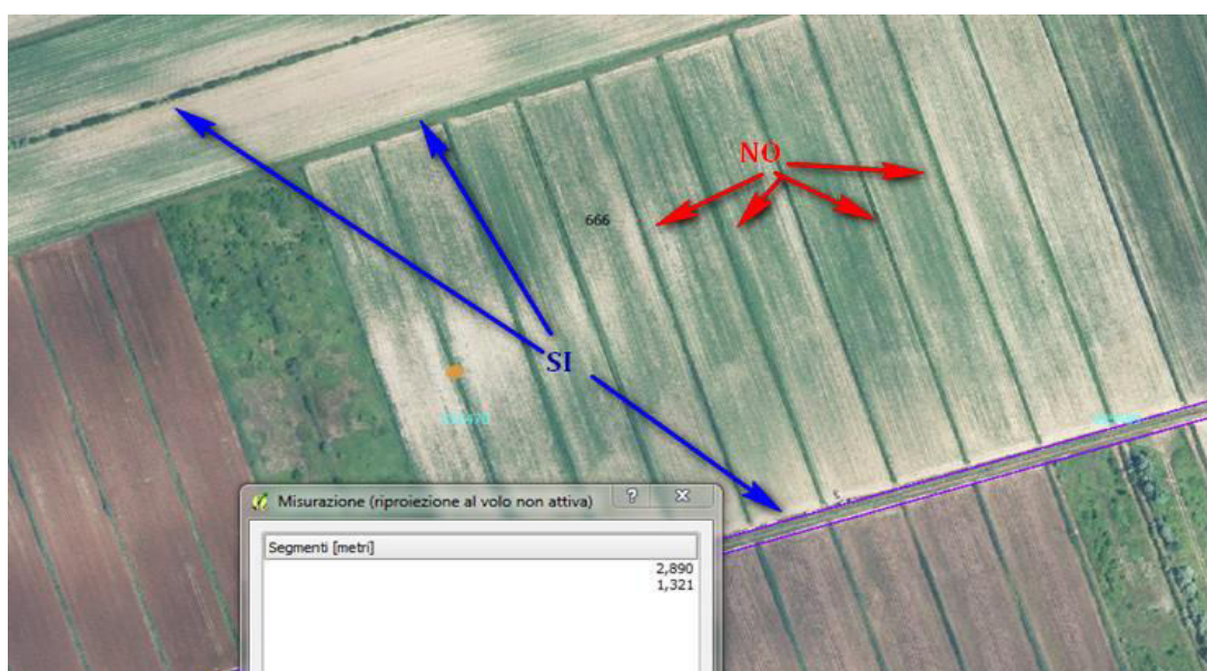
Figura 100 - Modalità di digitalizzazione dei canali
