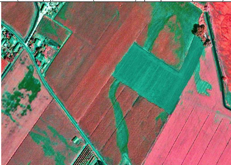
VHR estiva (Quickbird) – stessa distinzione culturale con ben evidenti zone danneggiate da ristagno e deflusso idrico, in zone con e senza presenza di scoline (Condizionalità- BCAA)
