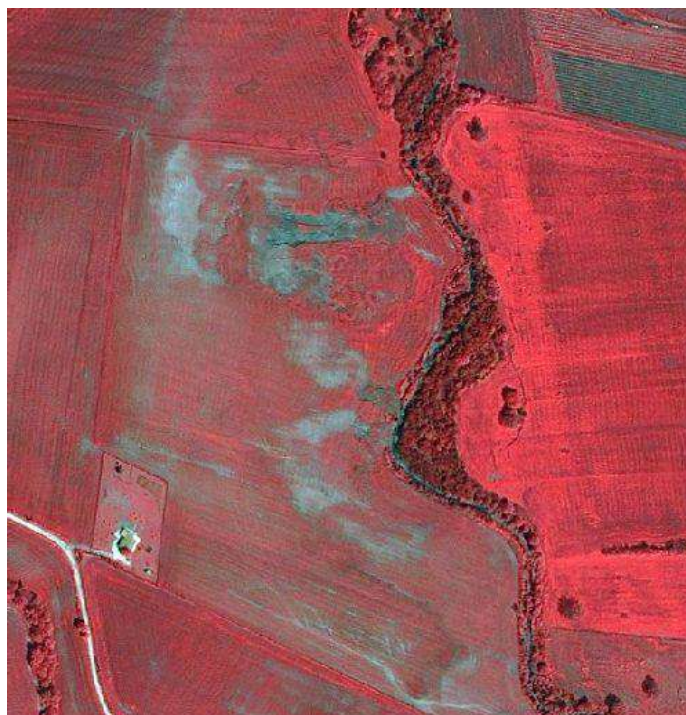
Esempio di frana
