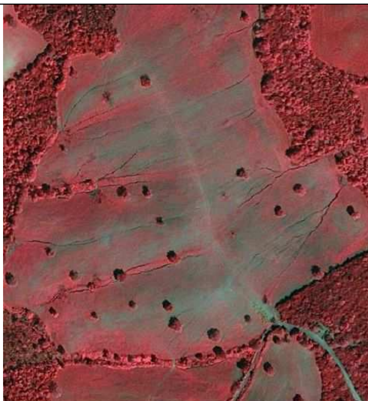
Figura 20 - Esempi di solchi prodotti dall'azione erosiva dell'acqua in assenza di assoltature superficiali
